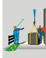
4 Richtiges Verhalten beim Anschlagen von Lasten
